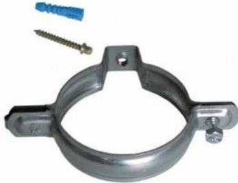
Percez le mur en tenant compte du positionnement de la descente et fixez-y les [colliers](#) à l'aide de pattes à vis (comptez un collier par mètre)
