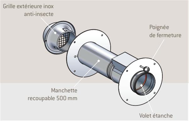
Le Kit d'air comburant étanche de diamètre 80, 100 et 125 permet une amenée d'air comburant à travers un mur vers un poêle à bois. Il est composé d'une grille extérieure esthétique, d'une manchette recoupable équipée d'un volet étanche et d'une poignée d'ouverture. Il peut être associé à une coquille de laine de roche en option.
