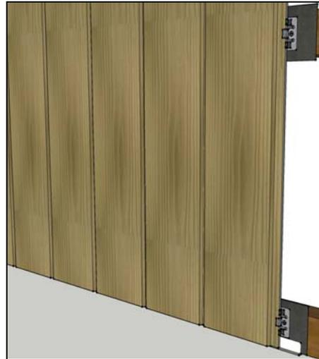
Si les CEDRAL CLICK sont fixés par agrafes, ils sont supportés par un profil en aluminium en L. Le profil de départ est mis parfaitement horizontal et fixé par des vis à tête fraisée appropriées de sorte que la tête de vis ne bloque pas le placement des CEDRAL CLICK. En fonction des dimensions du profil en L, la latte de support du profil en L doit être plus mince que la latte où sont fixées les agrafes. (Voir le dessin G0167). Un profil de support doit être prévu au moins tous les 3,60 m.
