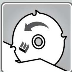
Utiliser exclusivement une lame de scie prévue pour les produits en fibres-ciment.
