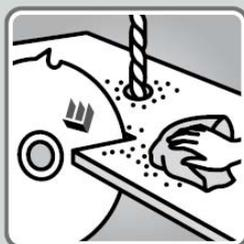
Éliminer immédiatement la poussière de sciage et de forage avec un chiffon en microfibre propre.
