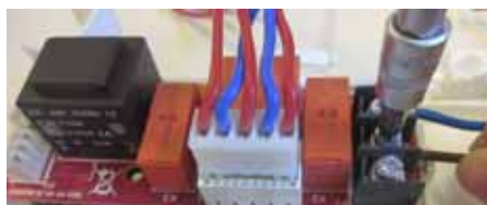
Raccorder le câble d'alimentation sans oublier la terre
