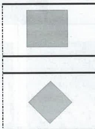
On peut positionner le corps de la ventilation en carré ou en losange par rapport au bac.
