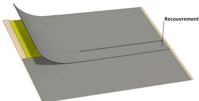
Mise hors d'eau provisoire et/ou étanche au vent :
