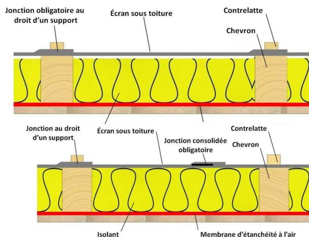
Mise hors d'eau provisoire et/ou étanche au vent :
