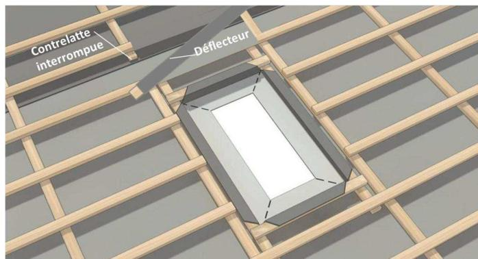
**Mise hors d'eau provisoire et/ou étanche au vent :** Fixer les relevés par collage, au moyen de THERMO TAPE FACADE PES 60, THERMO BUTYL, THERMO KLEB&DICHT selon la nature du support avec lequel raccorder l'écran. Le traitement des angles sera réalisé avec THERMOFLEX.
