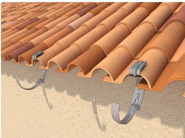
Si votre toiture en tuiles ne vous permet ni de fixer sur bandeau ni sur chevrons, optez alors pour **les crochets pince à emboîtement sur tuiles**, toujours à poser tous les 50 cm.
